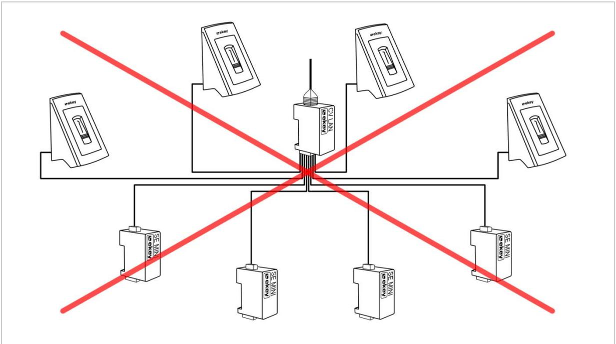
Abb. 2: Nicht erlaubte sternförmige RS-485-Verkabelung
